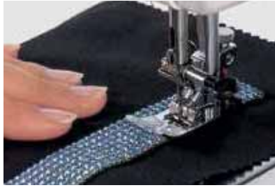
水晶网布 在石带的第一排与第二排水晶元素之间缝上，或使用「之」字针步。 注：请参阅第 114 和 119 页关于承托薄膜的有用资料。
