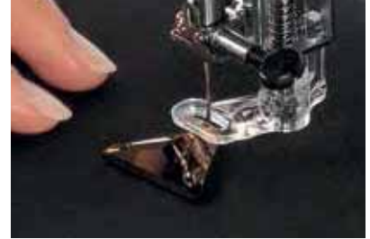
手缝石 不需用下料功能，并根据产品调校缝线宽度。
