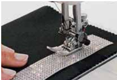
水晶片石带 在各排水晶元素之间缝上。
