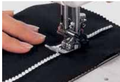
基本石带（单排） 确保基本石带平行滑过针脚。
