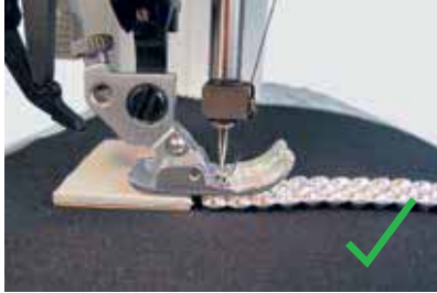
高度补偿器可使压脚平整。
