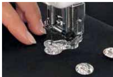
水晶钮扣 不需用下料功能，并根据产品调校缝线宽度。
