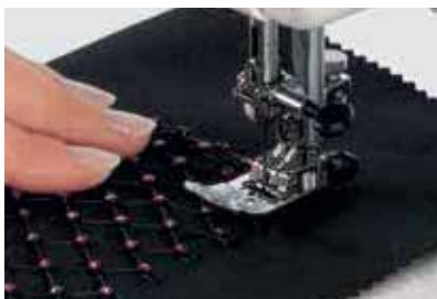
鱼网石带 调整针柱，以便在水晶元素旁边缝上。
