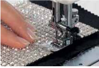
圆形水钻和平底石带 在石带的各排水晶元素之间缝上。
