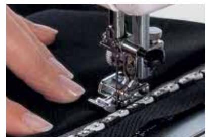
拉链 使用拉链针脚时，可紧靠链齿缝上。某些情况下，调整针柱亦非常有用。
