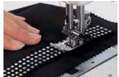
基本石带（多排） 在石带的第一排与第二排水晶元素之间缝上，如需要，用「之」字针步在角位加固。
