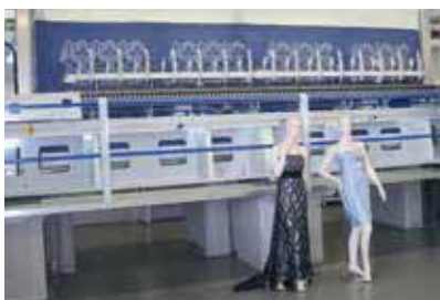
4 使用 Laesser 水晶石绣装置 (图中所示) 或田岛中孔石刺绣装置等系统实现自动刺绣工序。
