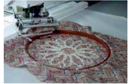
在工业刺绣流程中，外框可使轻薄且有弹性的布料保持稳定。
