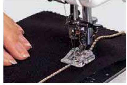
爪链 确保爪链笔直滑过针脚。
