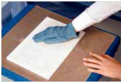
6 将产品取出后，使用熨布或防热手套对产品施加压力。
