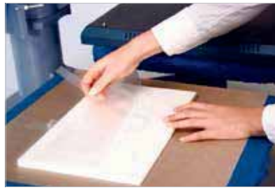
7 产品完全降温后，在烫贴膜的帮助下，按锐角方向撕去透明转移薄膜。
