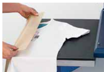
3 确保将水晶元素应用于推荐一侧，并使用正确的烫贴辅助用具。为保证加热面没有胶水残留物，最好使用特富珑®垫将其覆盖。
