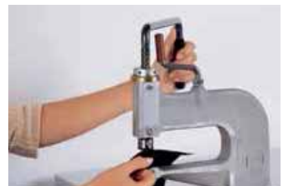
3 在所需的位置进行应用。利用可调式制动锁调节偏差 / 压力。
