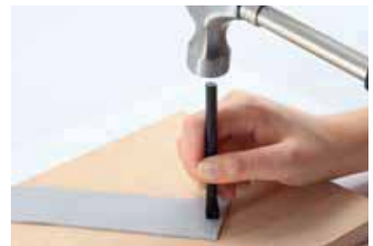
9 使用冲打纽扣孔工具(型号 9040/122)打钮孔。
