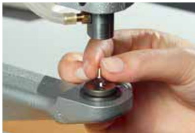
4 将水晶窝钉的底部放於下模。
