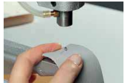
6 将预先打孔的承托物料放在底部上面。
