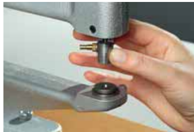
2 将相关工具放入手动螺旋压力机。确保工具保持笔直且牢固安装。
