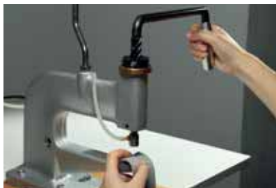
7 通过闭合把手，将水晶窝钉牢牢固定。
