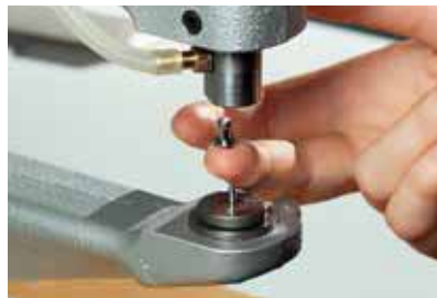
5 将水晶窝钉的顶部放入上模（水晶元素向上）。
