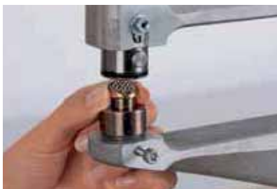
1 将牛仔扣的顶部放入上模。
