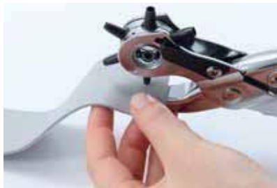
1 在水晶窝钉的指定位置，预先为承托物料打孔。
