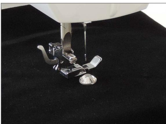
缝纫手缝石时需要将下定针关上。
