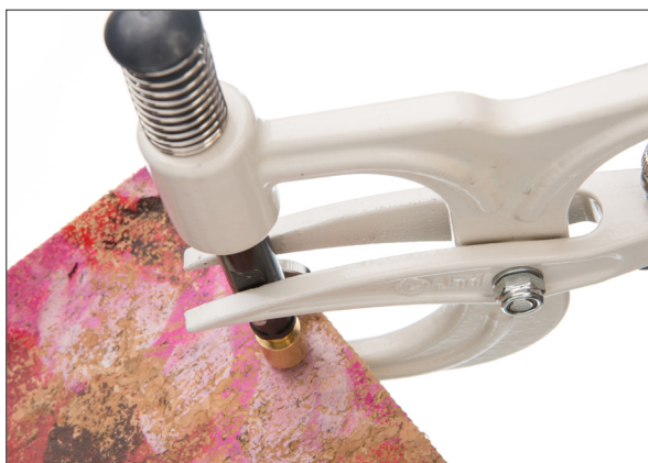
3. 将面料置于上下模具中间·平底石饰针位于您想要的位置·确保在面料的正确一面穿孔·挤压饰针固定器的手柄；
