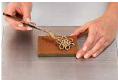
4 将焊好的爪链从模子里取出。
