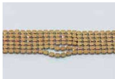
焊料太少 焊料太少，以致焊缝不能填满，因此接缝不牢固。
