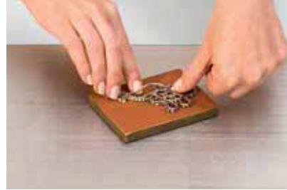
3 将原样板压入合适的印模材料。
