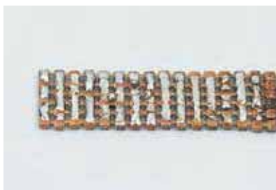
焊料太多 焊料过多将导致爪杯堵塞，高温焊料亦会损坏镀底，电镀之后，这损坏会产生镀底表面出现腐蚀，及致使镀底摧毁，而此类焊接错误只能在电镀后方可察觉。
