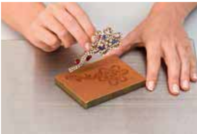
4 材料固化后方可除去原样板。
