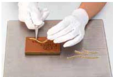
2 将爪链放在焊模里。
