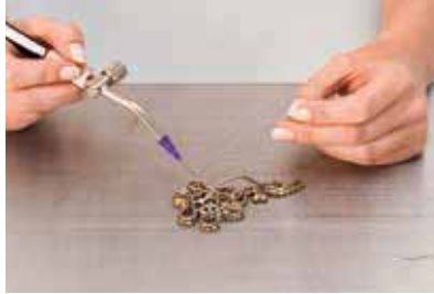
2 通过背面的焊线强化原样板。
