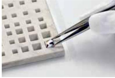
2 在材料后部，将平底石以末端向上的方式置于端对端镶嵌孔内。
