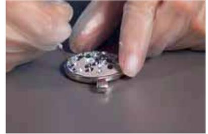
3 使用真空吸取设备、镊子或蜂蜡棒捡起水晶元素。将水晶元素小心放入粘贴位置，并轻轻下压。
