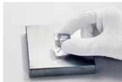
3 按压水晶元素，使胶水完全覆盖粘贴部位。
