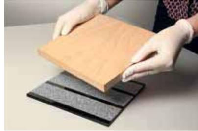
6 在胶水固化的过程中，建议在图案上加一些重量。
