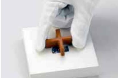
十字架（或类似工具）可避免水晶元素翻倒；用所选工具平按底材上的水晶元素。
