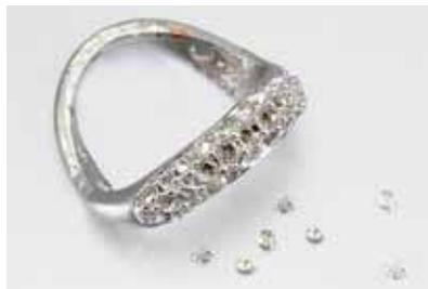
由于冲击吸收能力较差（约 10%），承受极端机械应力后，使用标准环氧树脂胶水粘贴的施亮™圆形水钻从镶嵌孔中脱落。
