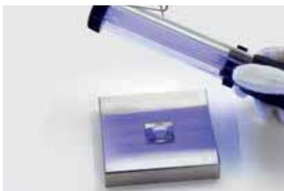
4 使用紫外光照射数秒钟让胶水固化（按照生产商说明），然后使用清洁剂清除多余的胶水。接着可按照生产商说明继续固化流程。
