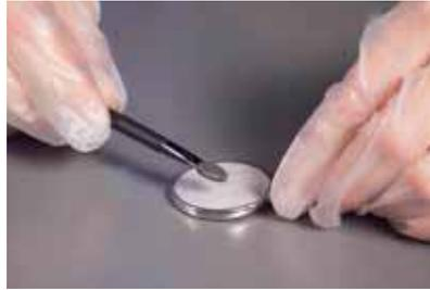
2 将表面塑造成所需的形状，并用建议的脱模剂让表面变得光滑。
