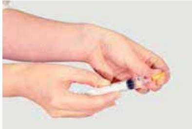
两种成分完全混合后, 将胶水放进配量器 / 注射器, 然后装上点胶针头。
