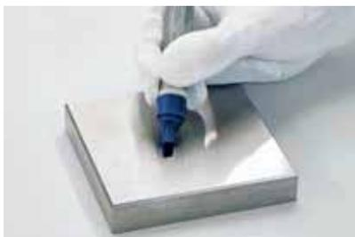
1 待涂抹胶水的表面必须经过合适的预处理，才能获得充足的表面张力。利用测试笔可进行测试（型号 9030/000）。
